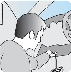
**Schritt 2:** Datenkabel Ihres bluefins an den Diagnosestecker anschließen.
